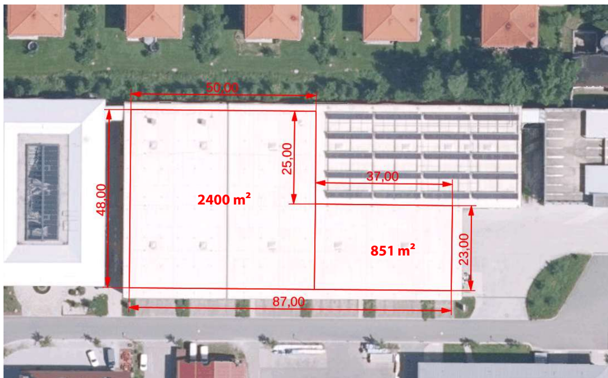
Abbildung 10: Darstellung der freien Dachfläche (Angaben in Metern; aus RIWA-GIS)
